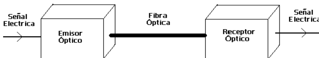
Figura IV.3 Sistema de comunicación por fibra óptica.
