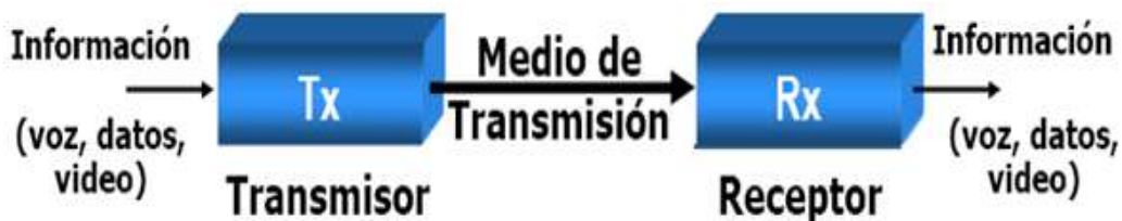
Figura IV.1 Sistema de telecomunicaciones.
